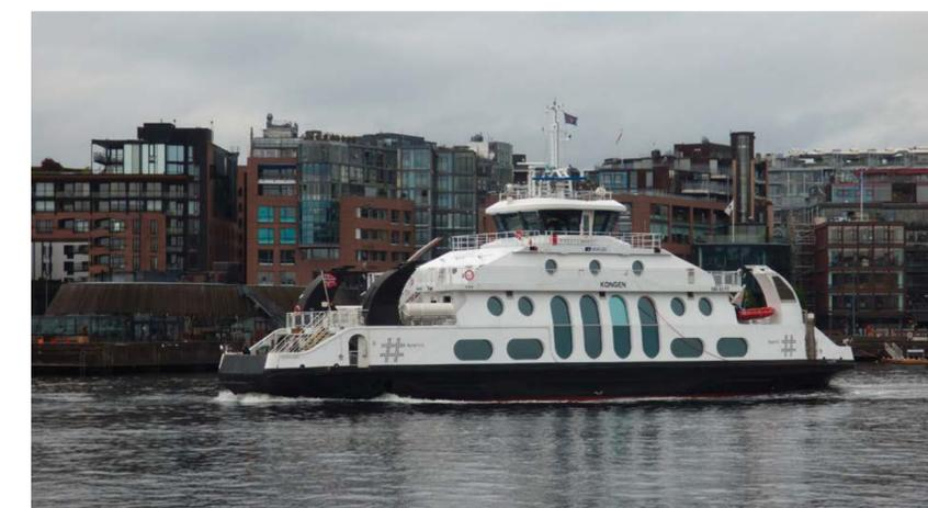
Die KONGEN war auch im Einsatz. Der ursprüngliche LNG-Antrieb wurde 2019, wie bei den beiden Schwesterschiffen auch, durch einen Batterie-Antrieb ersetzt.
